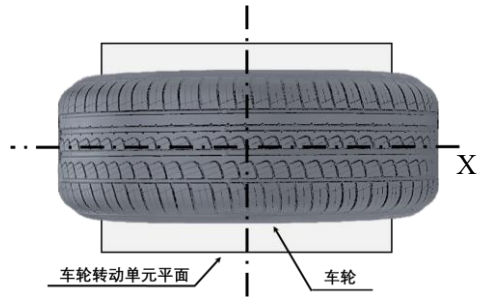
图3 车轮安装放置车轮转动单元平面示意
